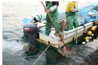
従来のクラゲ駆除方法の例<sup>[1]</sup>: 漁網でクラゲを集めて小型船舶の船外機などを用いて粉碎して駆除
