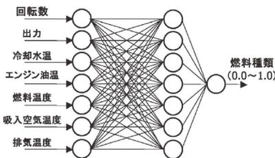
図5. 燃料種類判別ニューラルネットワークのモデル
