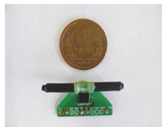
図2. RF-IDセンサタグ (被測定側)
