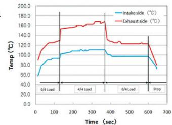
図4. ピストン温度測定結果
