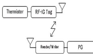
図1. RF-ID 測温システム構成図
