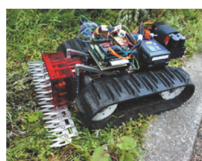
図1. 開発しているバリカン型草刈システム
