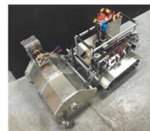
図2. 開発しているフレイル型草刈システム
