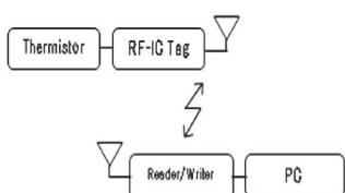
図1. RF-ID 測温システム構成図
