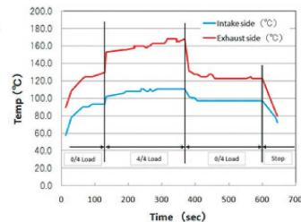
図4. ピストン温度測定結果
