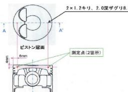
図3. ピストン温度測定箇所
