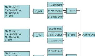
図6. PID+NNエンジン制御モデル
