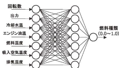
図5. 燃料種類班別ニューラルネットワークのモデル
