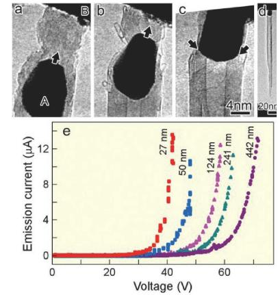
図2 (a)-(c)CNTのナノ溶接過程と(d)作製した単一CNT電子エミッタの(e)電界放出特性
