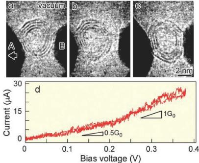
図1 (a)-(c)カーボンナノカプセルのマニピュレーション過程と(d)(c)の状態で測定した電流-電圧曲線
