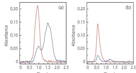
図2. カドミウム (赤) およびバックグラウンド (青) の信号プロファイル
