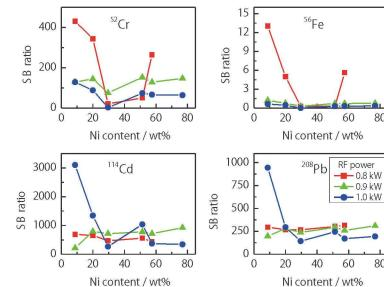
図1. 目的元素のSB比に及ぼすシールド素材中のNi含有率の影響
