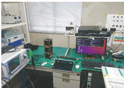
図2. 超小型衛星FUT-SAT-1の機能試験の様子
