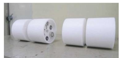
図3.光核反応X線分光器 光核反応中性子量をバブル検出器で計測します
