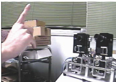
図2. NM網膜を用いた両眼視ロボットビジョン
