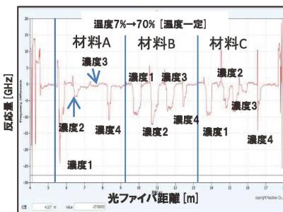
図2. 吸水性材料コーティングによる湿度反応計測結果
