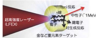
図1. 超高強度レーザーによる種々の量子生成の様子
