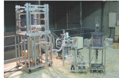
図1. 開発した酸化セリウム回収装置
