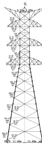
図4. 鉄塔の最適形状
