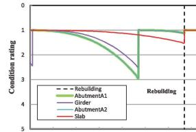
図2. 橋梁の補修時期の決定
