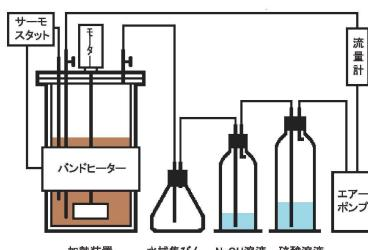
図2. アンモニアストリッピングの実験装置
