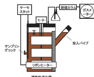
図1. 嫌気性消化の実験装置
