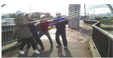
図1. ケーブルの強制振動の状況
