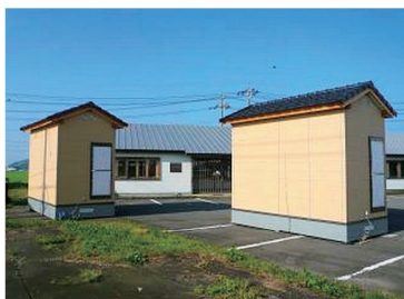
日射を遮る外壁の模型実験棟
