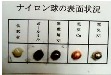
写真2 ナイロンボールの表面金属化
