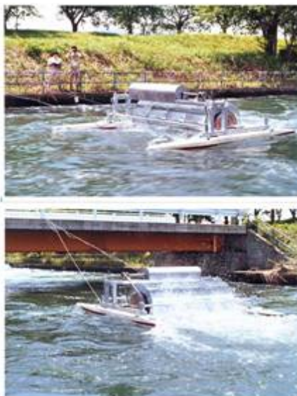
(1) フロート係留式小型発電装置
