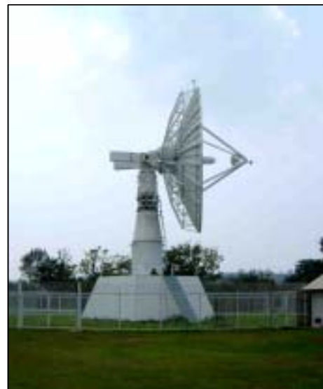
図1 . MODIS の受信設備 (芦原キャンパス)
