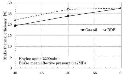
図1. 軽油とBDFを使用し正味平均有効圧力0.47MPaにおいて測定された燃料噴射圧力に対する正味熱効率の変化
