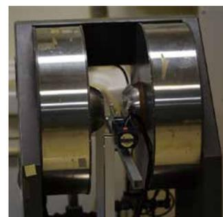
図3. 磁場印加実験を行うための電磁石
