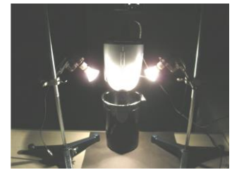
北潟湖で採取した湖水や泥水の分光反射率を計測する実験の様子。中央が分光器。
