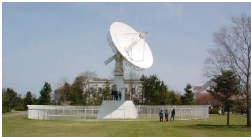
あわらキャンパスにある直径 10mのパラボラアンテナ（米国 ViaSat 社製）
