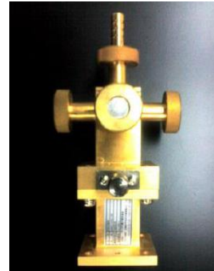
本研究室で開発した クロスパイプ型マイクロ 波空洞共振器
