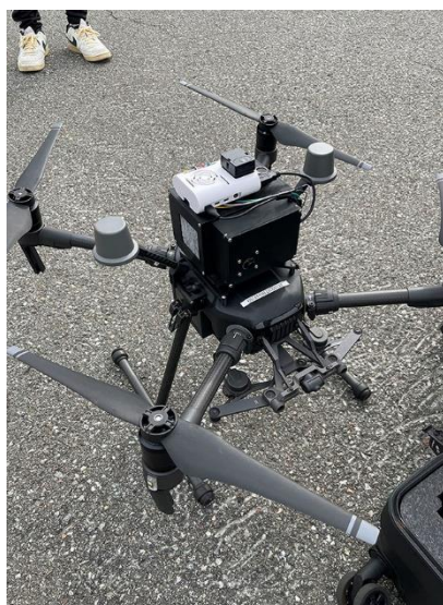
左) CO2 観測機器を搭載したドローン 右) 解析ソフトによる 3D 表現
