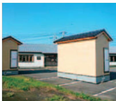
日射反射シートの実験棟
