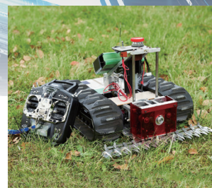
福井工業大学で開発中の バリカン型草刈ロボット
