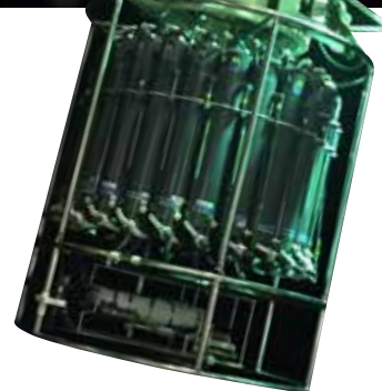
海水を採取する装置「CTDマルチサンプラー」
